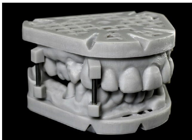
21 Verschlüsseln der Bisslage mit präzise gefertigten Fixierstiften aus Metall
