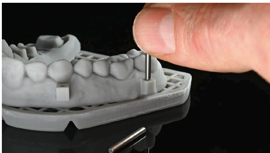
12 Nach dem 3D-Druck werden die Fixierstifte zum verschlüsseln der Okklusion eingesetzt
